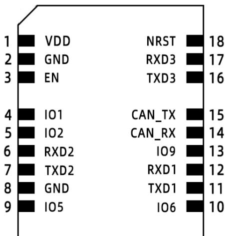
Figure15: CH040/CH040MP Pin Name
