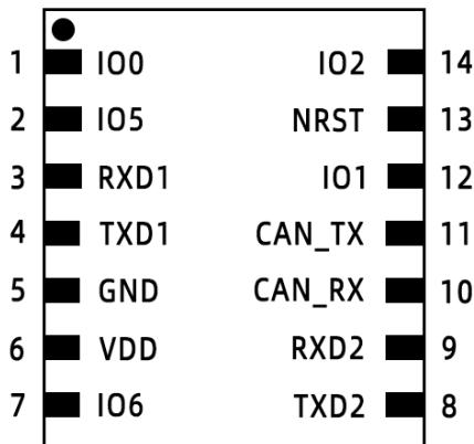
Figure14: CH010/CH020 Pin Name
