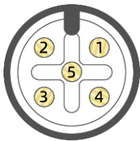
图 3: HI14 M12 5 芯 A 编码公头连接器序号
