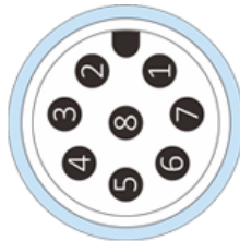
图 4: HI14 M12 A 公头连接器序号
